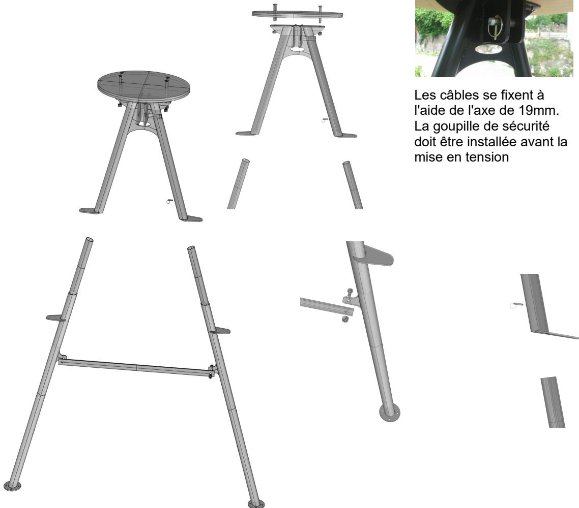
Les câbles se fixent à l'aide de l'axe de 19mm.
